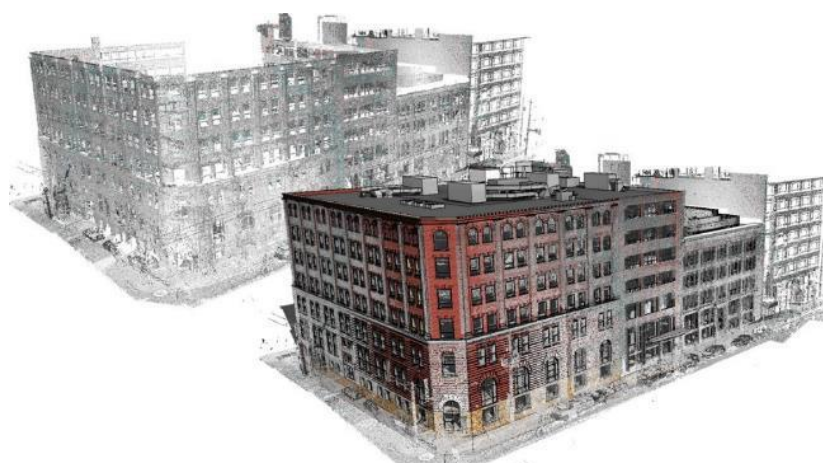
Figure 7. Modélisation sémantique d'un nuage de points en objets paramétriques dans un workflow BIM. Source : Autodesk
