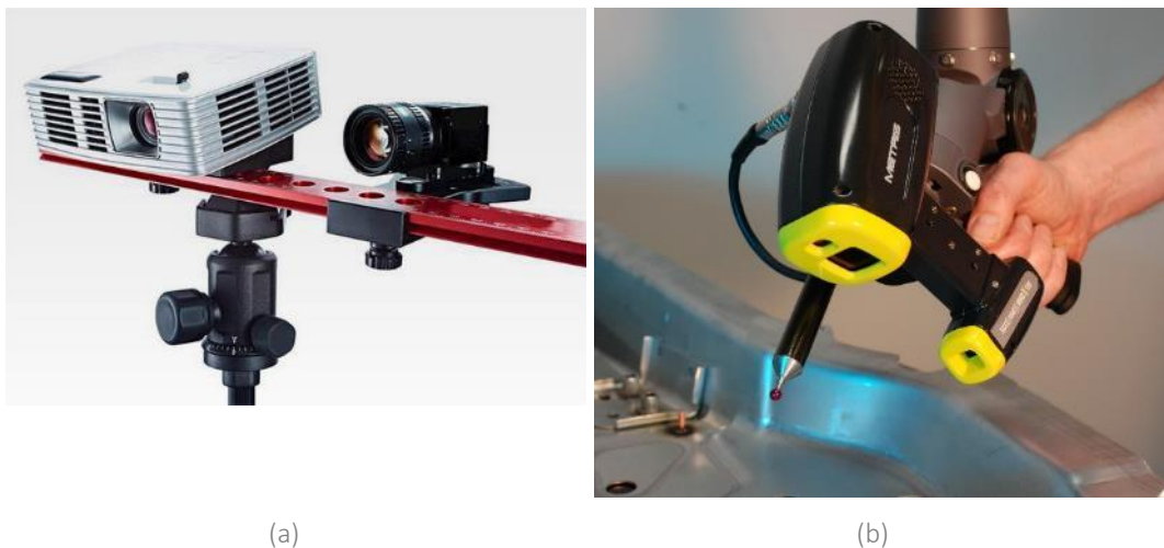
Figure 16. Scanner 3D par triangulation active pour la numérisation en environnement contrôlé : (a) lumière structurée (Source : HP) ; (b) laser linéaire monté sur un bras mécanique (Source : Nikon)
