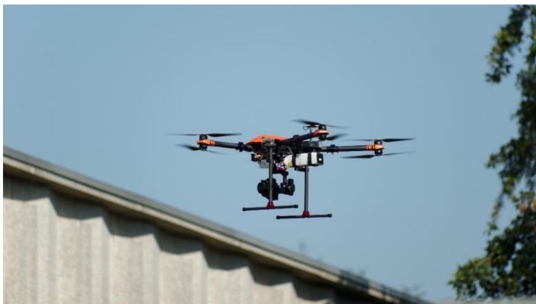
Figure 3. Utilisation d'un drone pour le relevé photogrammétrique d'un bâtiment. Source : CSTC, Drone TechniXX
