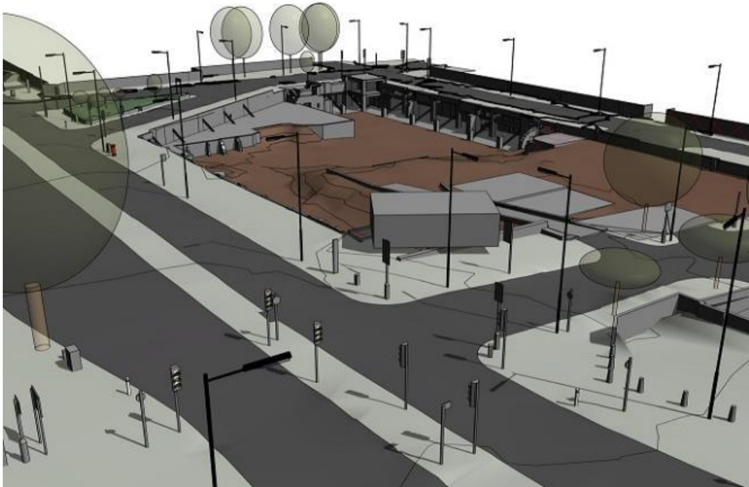
Figure 21. Modéliser une maquette topographique BIM à partir d'un relevé au scanner laser. Source : Bury Associates Ltd
