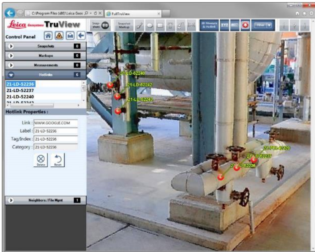
Figure 33. Logiciel Leica TruView conçu pour les professionnels désireux de visualiser et de mesurer des nuages de points sans connaissances approfondies en balayage laser, CAD ou 3D. Source : Leica
