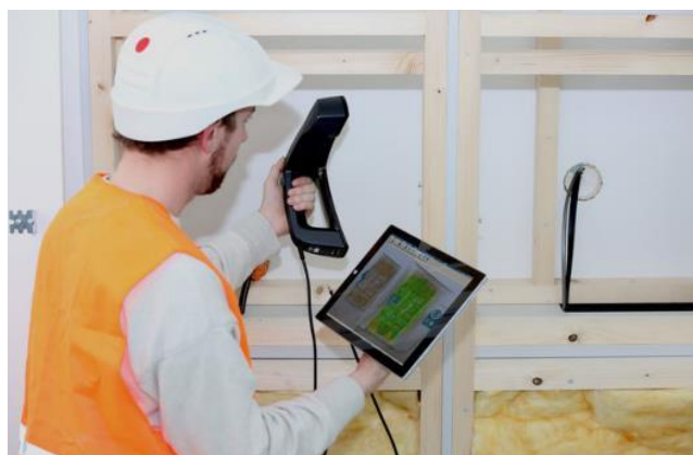
Figure 17. Scanner 3D par caméra à temps de vol produisant une acquisition en temps réel pour les espaces intérieurs. Source : Faro
