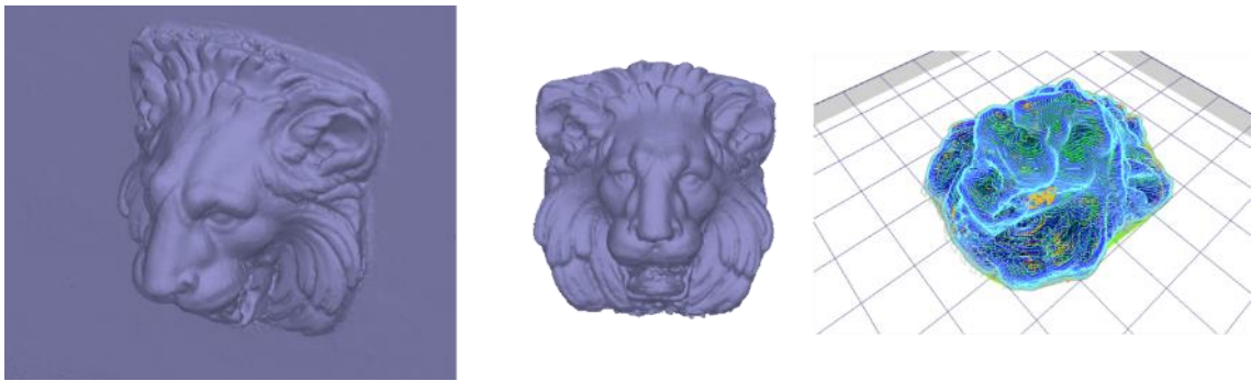
Figure 37. Réplique d'un ornement architectural : production d'un fichier CAM pour l'impression 3D à partir d'un maillage. Source : CSTC
