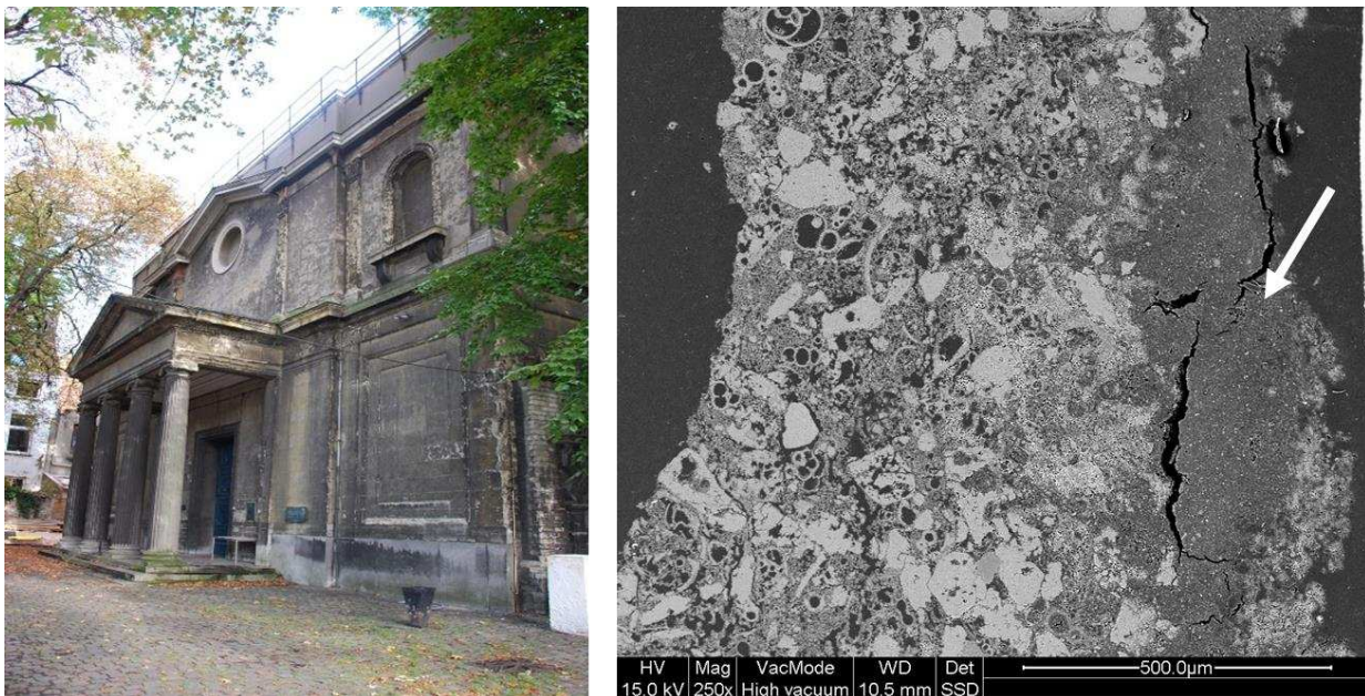
Figuur 4: Links: het 19 e eeuwse tempelgebouw (Campus Mutsaard, Antwerpen) in kalksteen, waaronder Avendersteen en pleisterwerk. De buitenkant is sterk vervuild. Rechts: SEM-BSE opname van een staal Avendersteen uit de gevel van het tempelgebouw met zwarte korst (witte pijl). ICP-OES analyse van de korst wijzen op 588 mg kg -1 Pb.
