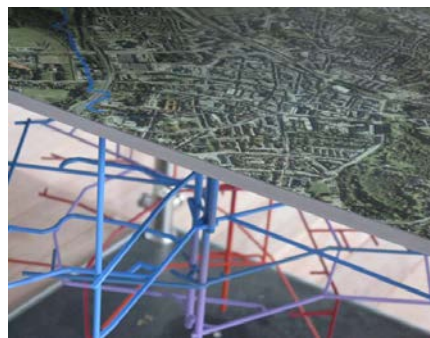
Mijnwaterproject Heerlen: evenredig met de diepte van de mijngangen kan er water met een hogere temperatuur worden opgeslagen in de ondergrond (bron: www.mijnwater.nl )
