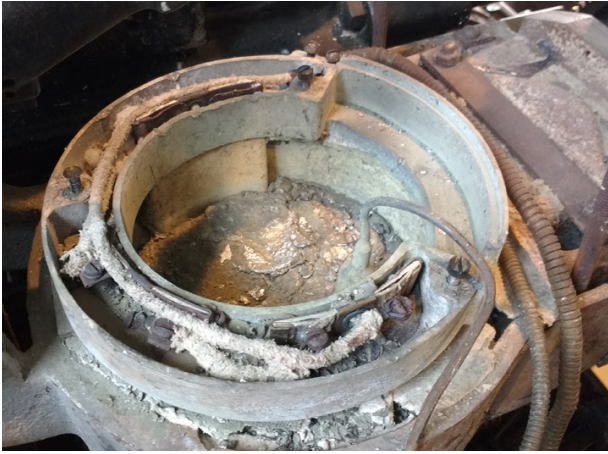
Voorbeeld van een minder gekende toepassing: asbest in de loodpot van een regelzetmachine (foto: Peter Loockx, 2022)
