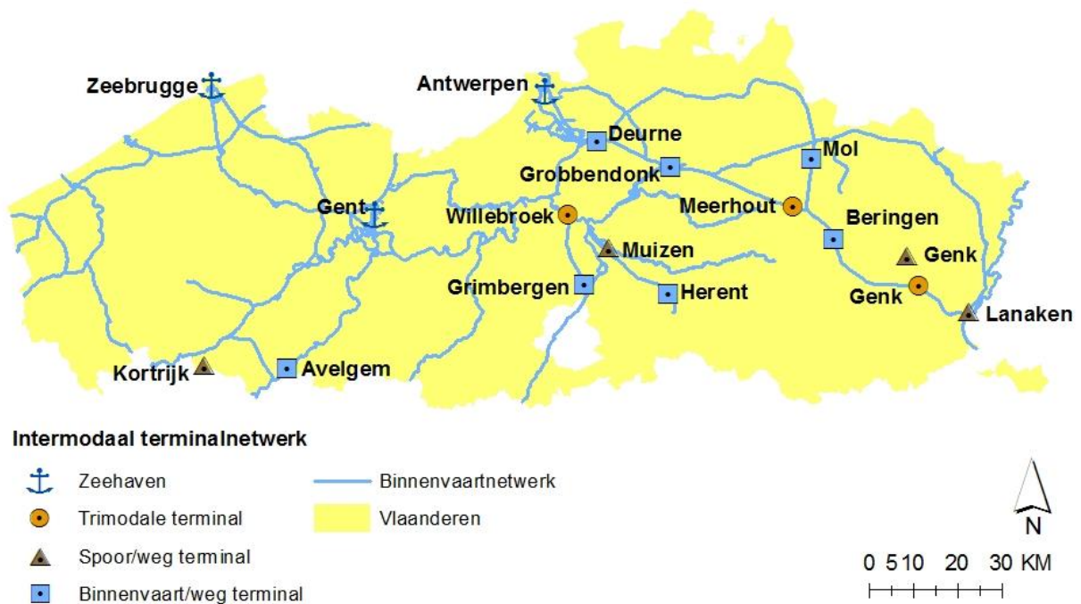
Figuur 4.27: Vlaams landschap van overslagterminals in het binnenland, voor de overslag van containers tussen spoor en weg en/of binnenvaart en weg. Bronnen: VUB-MOBI, 2014 voor Steunpunt MOBILO.
