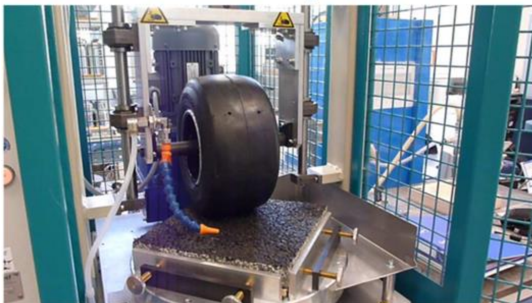
Figuur 4-9 Het Darmstadt Scuffing Device bij BAC (OCW) voor het uitvoeren van de rafelingsproeven [13 – Presentatie]
