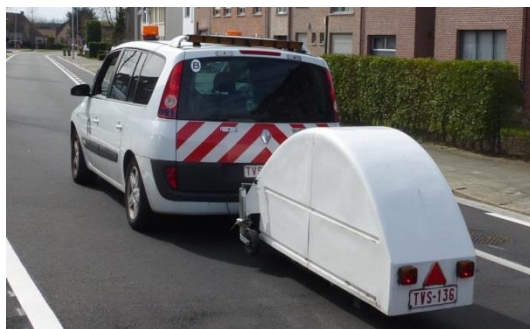
Figuur 2-9 (links) Aanhangwagen rolweerstand OCW - (rechts) Meetprincipe [4]
