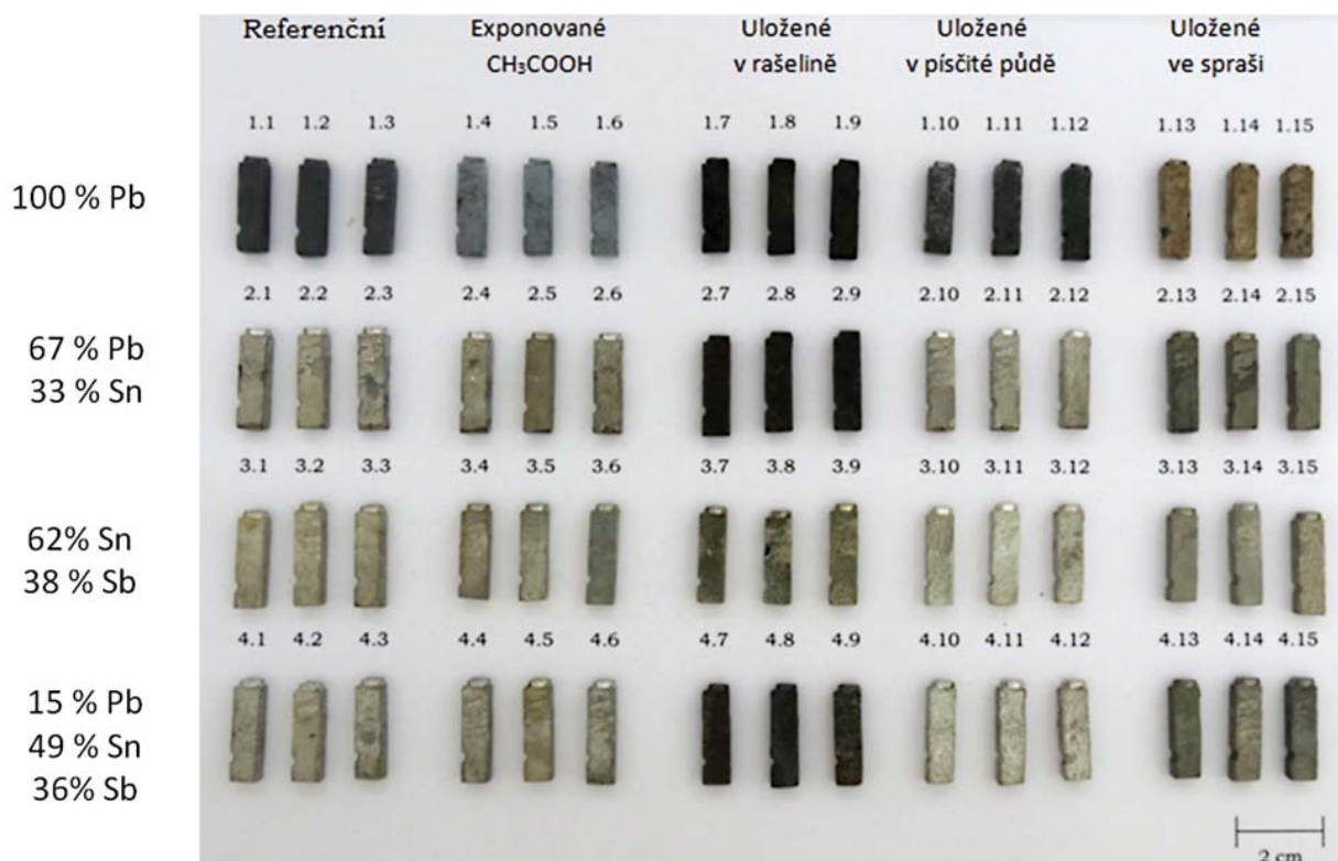
Obr. 9. Vzhled vzorků po korozní zkoušce
