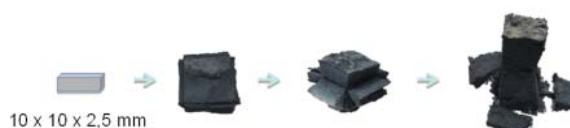
Obr. 14. Korozní rozvoj vzorku o složení 70Pb–25Sb–5Sn po 3 týdenní expozici v parách o složení 75 % HCOOH a 25 % CH 3 COOH při teplotě 60 °C [2]
