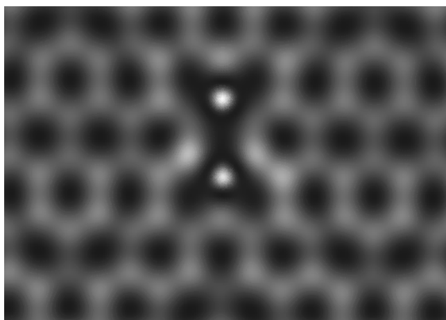
Figura 3.2: Imagen STM simulada correspondiente a la configuración más favorable (Para en los cis-clusters) de dímeros de F sobre grafeno (Fig. 3.1 a).
