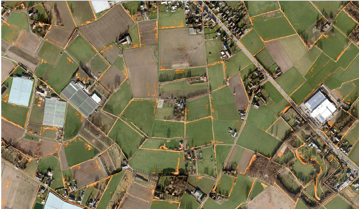
Figuur 27: aanduiding van micro-depressies met een oranje schakering. We zien dat deze kaartlaag ook de grachten identificeert. Deze grachten hebben meestal de klasse 1-2 en het is dus mogelijk deze te onderscheiden.
