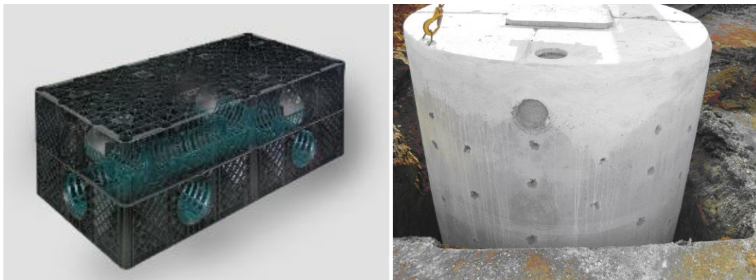
Figuur 18: infiltratiekralen (links) en een geperforeerde hemelwater put (rechts). Dergelijke geperforeerde hemelwaterputten worden rondom aangevuld met kiezel om het infiltratieoppervlak te vergroten.
